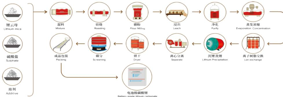
▲ 锂电新能源材料生产流程图
